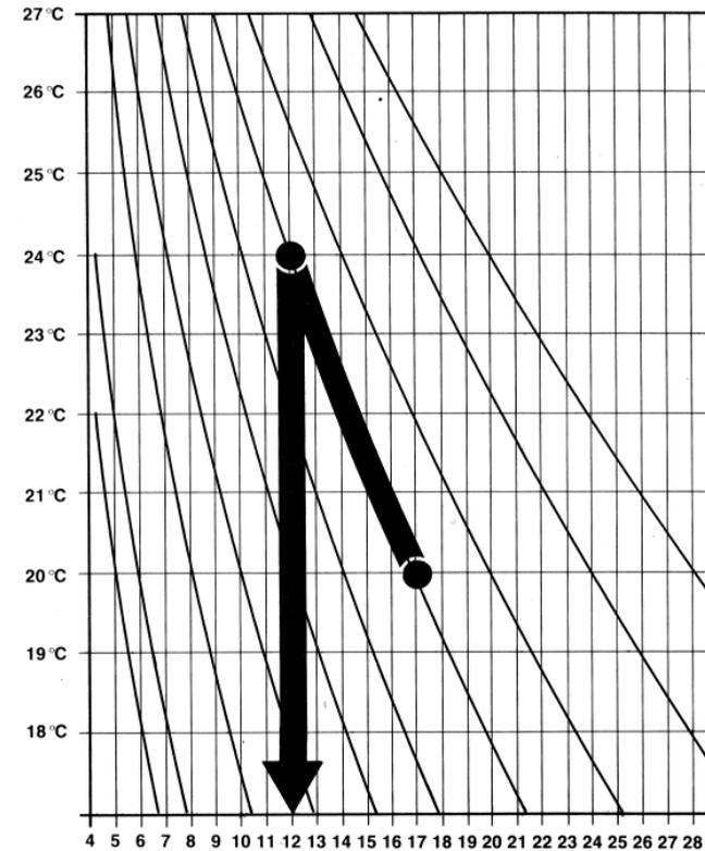
Der max. zulässige Temperaturunterschied zur gewählten Prozesstemperatur beträgt +4°C. Ist Chemie oder Wasser wärmer, startet das Gerät nicht und die Fehlermeldung "zu warm" erscheint. Wählen Sie in diesem Fall den 24°-Prozess, wenn der 20°-Bereich nicht ausreicht.
