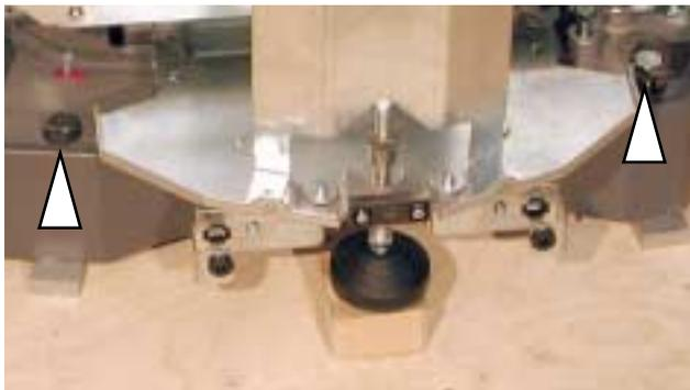
Entfernen Sie mit dem 17 mm Maulschlüssel die beiden am Sockel angebrachten Holzschrauben.
