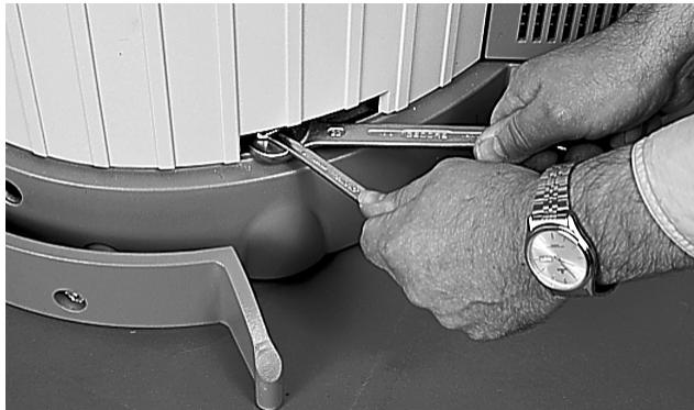
Haben Sie die FüÙe eingestellt, können Sie die Kunststoffabdeckungen links und rechts hinten einsetzen. Beachten Sie die Einbaulage. Sollte eine Abdeckung sich nicht einstecken lassen, dann umdrehen.
