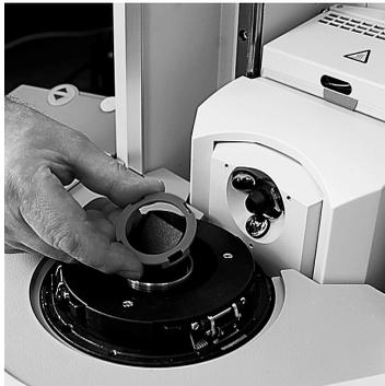
Entfernen Sie vorsichtig die Transportsicherung, die auf den Diaarm geklemmt ist.
