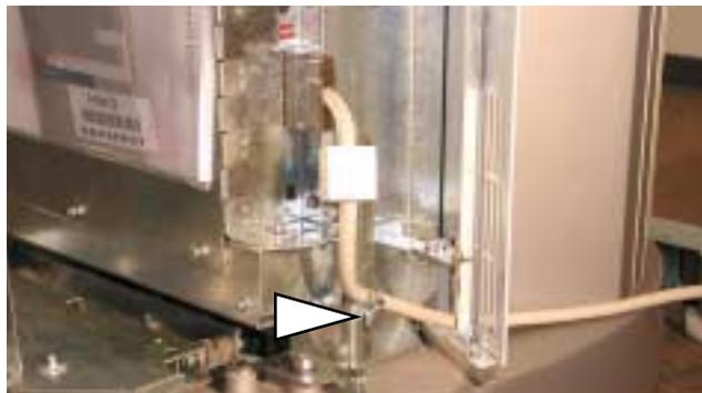
Führen Sie das SCSI-Kabel an der rechten Seite des Gerätes durch die dafür vorgesehene Aussparung und schließen Sie es an der Elektronik an. Befestigen Sie es anschließend an der abisolierten Stelle mit der dafür vorgesehenen Kabelschelle.
