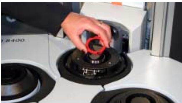
Entfernen Sie vorsichtig die Transportsicherung, die auf den Diaarm geklemmt ist.
