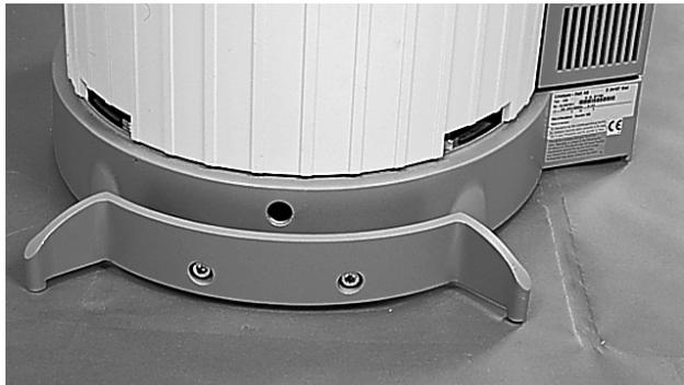
Schrauben Sie mit dem Innensechskantschlüssel 8 mm die Stützhilfe an den Scanner an. Diese verhindert das Umkippen des Gerätes.
