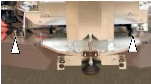
Nach dem der Scanner an seinen endgültigen Bestimmungsort gebracht wurde, müssen die Rollen versenkt werden. Dazu die Schrauben zurückdrehen, bis sie frei drehen. Sie benötigen dazu den Maulschlüssel 13 mm.
