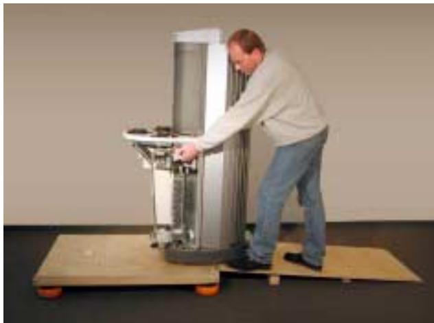
Fassen Sie dazu den Scanner an der Gußeisenhalterung an und nicht an Teilen des Magazintisches.
