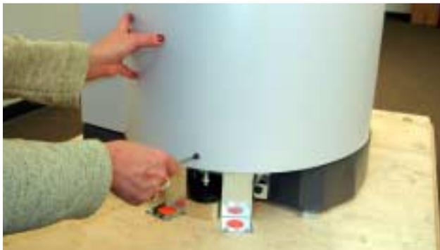
Drehen Sie mit dem Schlitzschraubendreher die Schraube im unteren Bereich der Frontverkleidung heraus.
