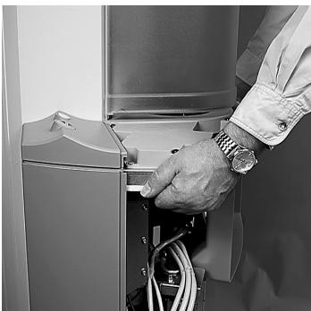
Bei Kurven kann der Scanner durch einseitiges Anheben am Trageblech in die richtige Richtung gedreht werden.
