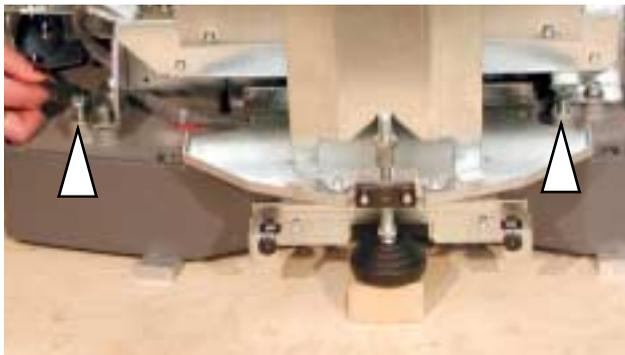
An der Vorderseite des Scanners müssen jetzt mit dem Maulschlüssel 13 mm die zwei vorhandenen Schrauben bis zum Anschlag eingedreht werden.
