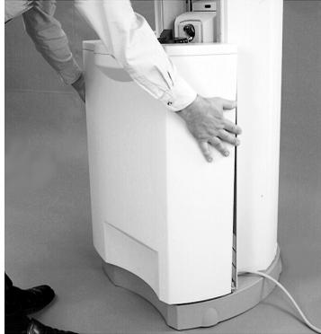
Beim Anbringen der Frontverkleidung müssen Sie darauf achten, daß 3 Nippel oben und unten die 2 offenen Langlöcher in die gelben Pins einrasten müssen. Anschließend befestigen Sie die Schraube an der Vorderseite mit dem Schlitzschraubendreher.
