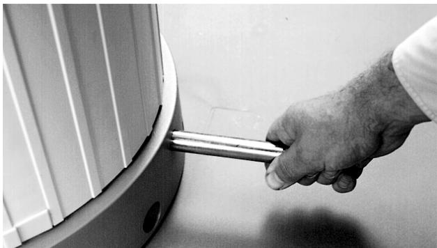
Ziehen Sie an der Rückseite des Gerätes die Transportsicherungs-Stange heraus.
