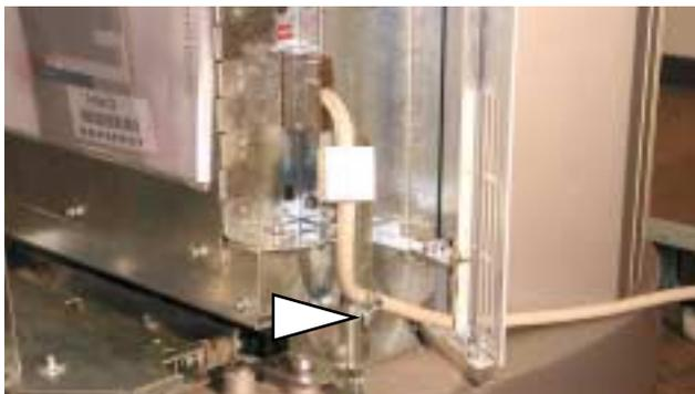
Führen Sie das SCSI-Kabel an der rechten Seite des Gerätes durch die dafür vorgesehene Aussparung und schließen Sie es an der Elektronik an. Befestigen Sie es anschließend an der abgeschirmten Stelle mit der dafür vorgesehenen Kabelschelle.
