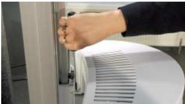
Setzen Sie den Deckel wieder auf und schrauben Sie ihn mit den Schrauben M 6x6 aus dem Karton Beistellteile fest.
