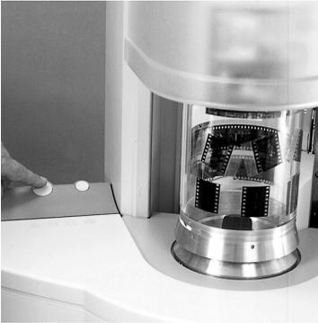
Mit der Taste Walzenwechsel wird die Haube geöffnet und die Walze zum Wechseln freigegeben. Nach dem Walzenwechsel wird durch Tastendruck die Haube geschlossen und die Walze verriegelt. Das Gerät ist scanbereit.
